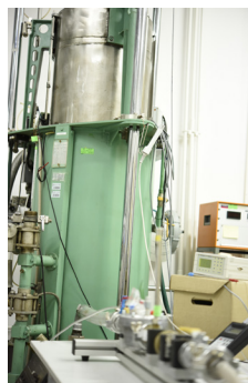
Wzorcowanie przepływomierza masowego (wodą)
