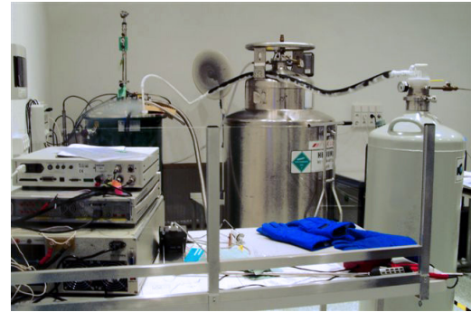
Państwowy wzorec rezystancji – kwantowy wzorec Halla
