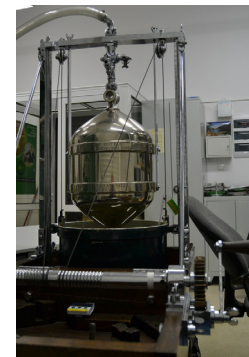
Kolba pomiarowa o objętości nominalnej 25 dm 3
