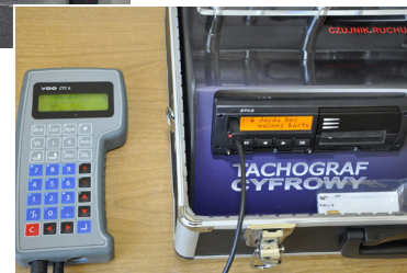
Tachograf cyfrowy w wersji szkoleniowej oraz przyrząd do jego kalibracji i sprawdzania
