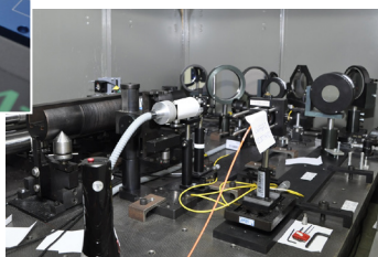
Stanoisko pomiarowe do wzorcowania długich płytek wzorcowych – komparator interferencyjny
