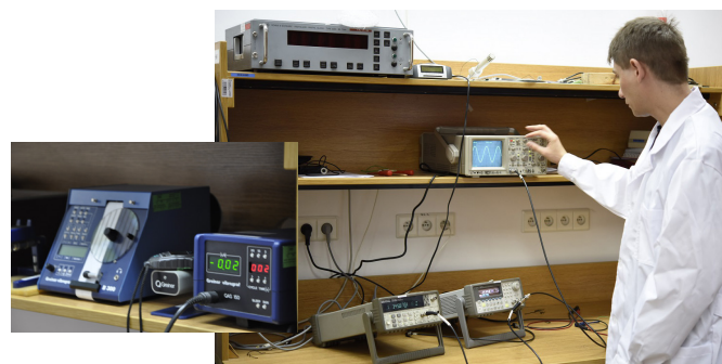
Pomiary na stanowisku do wzorcowań przyrządów w dziedzinie czasu i częstotliwości
