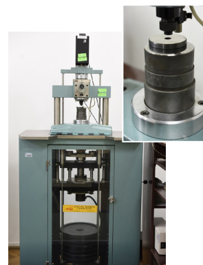
Stanowisko do wzorcowania wzorców twardości Rockwella
