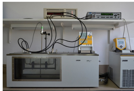
Stanowisko do przekazywania jednostki miary przewodności elektrycznej właściwej elektrolitów
