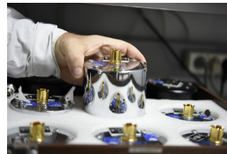
Państwowe wzorce napięcia AC – termiczne przetworniki AC/DC oraz indukcyjności – cewki wzorcowe
