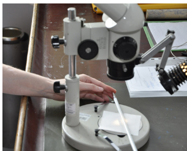
Badanie wstępne termometru szklanego cieczowego, stanowisko pomiarowe wzorca roboczego w zakresie od -80 °C do 550 °C
