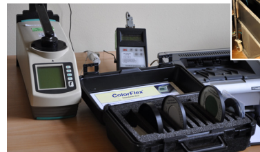
Stanowisko pomiarowe do wzorcowania wzorców współczynnika luminancji w geometrii 45°:0°
