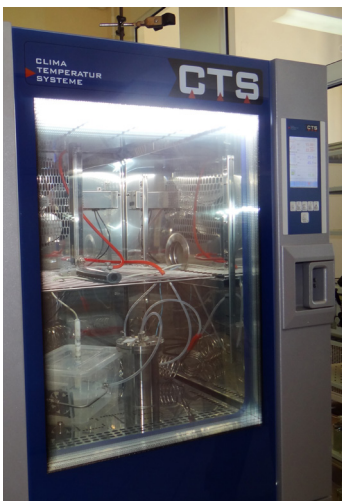
Stanowisko pomiarowe wzorca odniesienia wilgotności względnej od 10 % do 98 % dla temperatur powietrza od -40 °C do +95 °C
