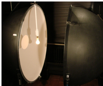
Stanowisko pomiarowe do odtwarzania państwowego wzorca jednostki miary strumienia świetlnego
