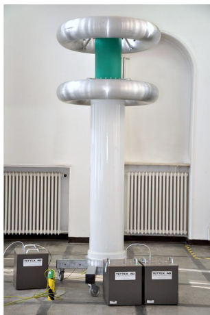
Państwowy wzorzec stosunku napięć AC (50 Hz) – dzielnik pojemnościowy i wzorzec odniesienia energii elektrycznej czynnej AC – jednofazowy licznik wzorcowy
