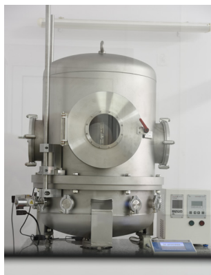
Automatyczny, próżniowy komparator masy AVK-1000
