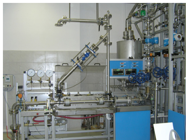
Stanowisko wzorca odniesienia jednostki objętości przepływu i strumienia objętości cieczy – badanie wodomierzy w pozycji 45°
