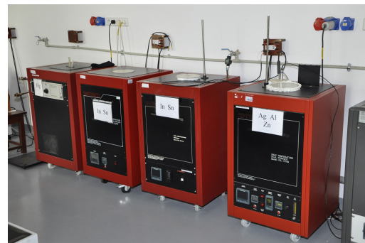
Stanowisko pomiarowe państwowego wzorca jednostki temperatury
