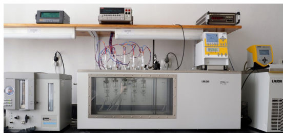
Stanowisko państwowego wzorca jednostki miary pH
