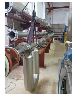
Wzorcowanie przepływomierza masowego (wodą)
