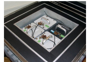
Państwowe wzorce napięcia AC – termiczne przetworniki AC/DC oraz indukcyjności – cewki wzorcowe
