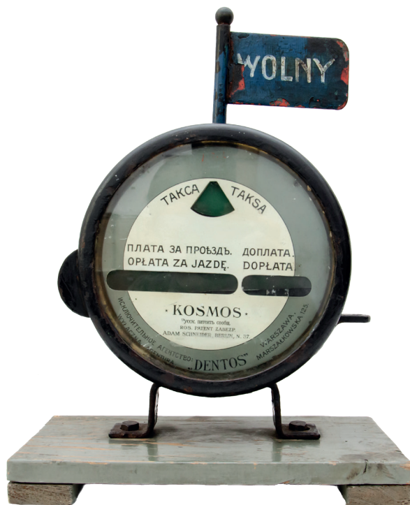
Il. 6. Taksometr „Kosmos” nr 1758 (12593) – ok. 1900–1910; metal, szkło; wymiary: 225 mm × 130 mm × 385 mm; wytwórca: Adam Schneider, Berlin, N. 37. Taksometr dwutaryfowy stosowany do dorożek konnych jak i samochodowych. W Warszawie dystrybucją zajmowała się firma Dentos z siedzibą przy ul. Marszałkowskiej 125 (syg. GUM 016-003324)
