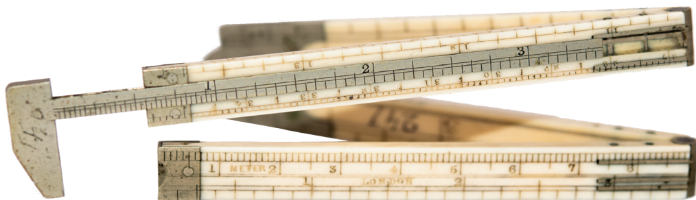
Il. 5. Przymiar trójprzegubowy z suwmiarką – ok. 1875 r.; kość słoniowa, mosiądz; wymiary: 363 mm × 3 mm × 9 mm. Oznaczenia kreskowe i cyfrowe: metryczne (centymetry), cale angielskie, rosyjskie werszki. Przymiar używany był przez kupców angielskich handlujących z Rosją skórami i drogimi kamieniami. Suwmiarka służyła jako karatomierz (syg. GUM 016-025161)
