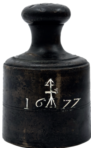
Il. 7. Odważnik Kościeszka 4 funtowy – 1677 r.; brąz; masa: 2799,1 g; wymiary: 75 mm × 71 mm × 110 mm (syg. GUM 016-025182)
