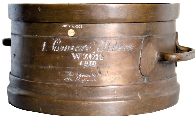
Il. 2. Ćwierć korzec nowopolski – 1819; miedź; wymiary: śred. 448 mm, wys. 250 mm; pojemność 128 l; wykonawcy: Al. Chodkiewicz i An. Dąbrowski. Wzorzec objętości do odmierzania produktów sypkich wg. systemu nowopolskiego (syg. GUM 016-003360)
