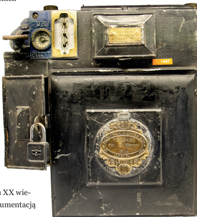
Il. 1. Gazomierz miechowy przedplaceniowy – 1914; blacha, szkło; wymiary: 320 mm × 185 mm × 360 mm; wytwórca: Schirmer – Richter. Liczydła wskazywały: porcję gazu, ilość gazu aktualnie zużytego, całkowitą ilość gazu zużytego przez odbiorcę (syg. GUM 016-028401)
