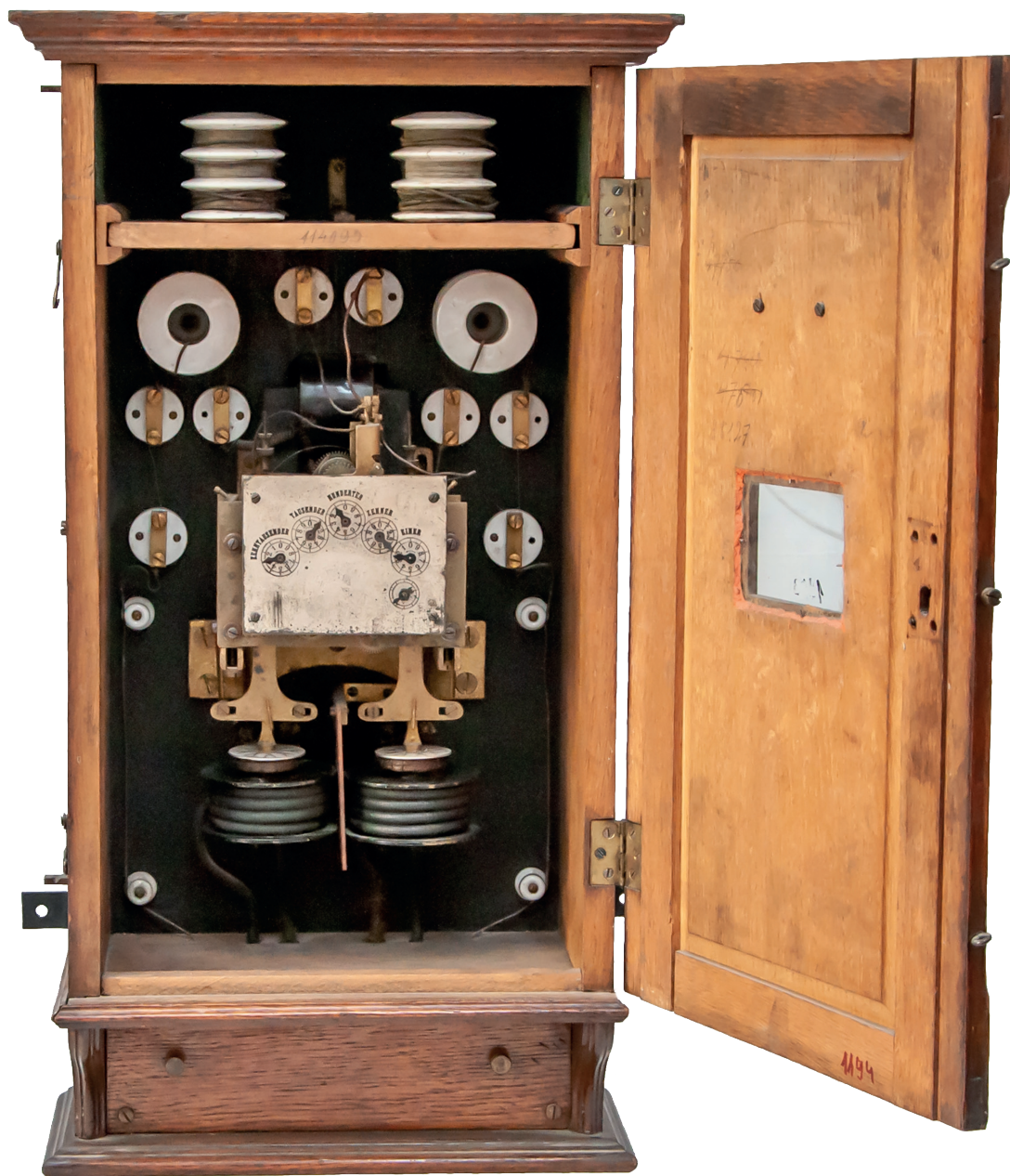
Il. 3. Dwuwahadłowy licznik energii elektrycznej 220 V, 50 A – ok. 1885 r.; drewno, ceramika, metal; wymiary: 315 mm × 200 mm × 574 mm; wytwórca: H. Aron (syg. GUM 016-003255)
