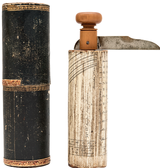
Il. 4. Przenośny zegar słoneczny – ok. 1832; drewno, mosiądz, papier; wymiary: 124 mm × 94 mm; wytwórca: Jan Baranowski. Zegar wskazywał czas słoneczny dla szerokości geograficznej 52° 13'. Wykres na walcu przedstawia zależność pomiędzy dł. cienia wskazówki, deklinacją słońca i kątem godzinnym słońca (syg. GUM 016-003284)
