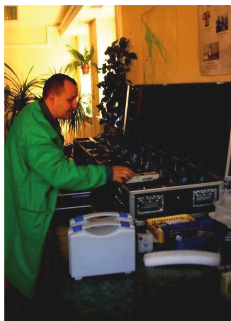
Rys. 11. Aktualne stanowisko do wzorcowania analizatorów wydechu
