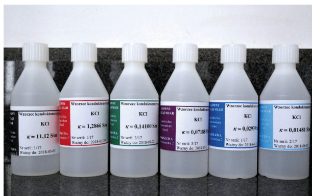
Rys. 3. Wtórne konduktometryczne materiały odniesienia sporządzane i wzorcowane w Pracowni Analiz Elektrochemicznych Samodzielnego Laboratorium Chemii GUM
