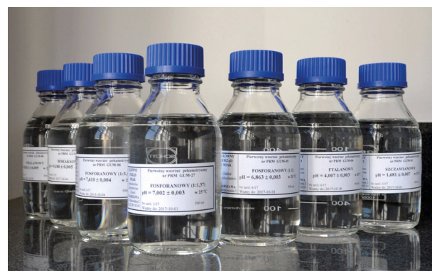
Rys. 2. Pierwotne materiały odniesienia pH sporządzane i wzorcowane w Pracowni Analiz Elektrochemicznych Samodzielnego Laboratorium Chemii GUM
