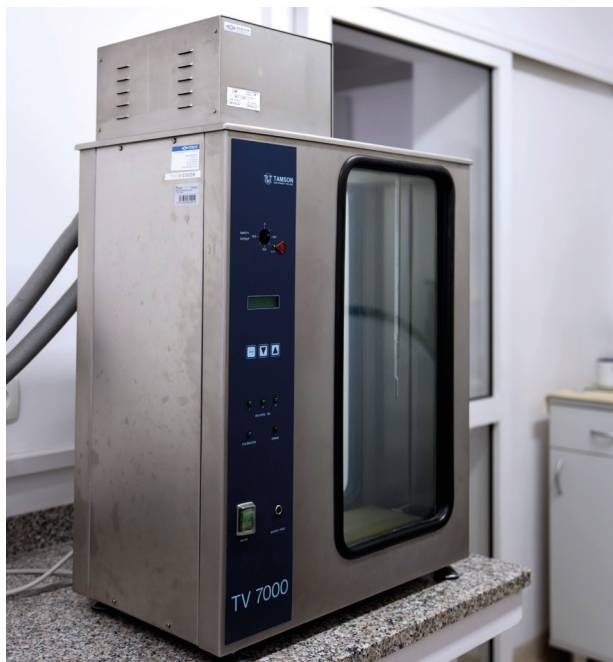
Rys. 5. Stanowisko pomiarowe, nr S03 – do wzorcowania wzorców lepkości cieczy w zakresie temperatur: (25 \pm 80)^\circ\text{C}
