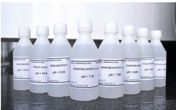
Rys. 2. Wtórne materiały odniesienia pH sporządzane i wzorcowane w Pracowni Analiz Elektrochemicznych Samodzielnego Laboratorium Chemii GUM
