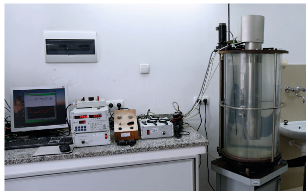
Rys. 4. Stanowisko pomiarowe (S01) wzorca odniesienia jednostki miary lepkości – do wzorcowania wzorcowych wiskozymetrów kapilarnych szklanych i wzorców lepkości cieczy w temp. 20 °C
