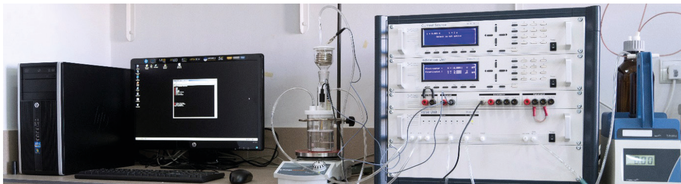
Rys. 2. Stanowisko pomiarowe do wzorcowania pierwotnych materiałów odniesienia jednostki miary ilości substancji w Pracowni Analiz Elektrochemicznych Samodzielnego Laboratorium Chemii GUM
