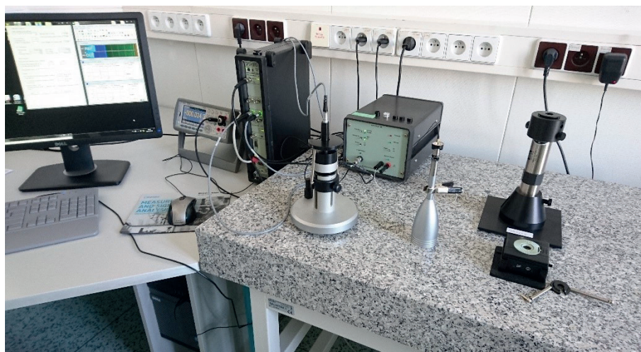
Stanowisko do wzorcowania kalibratorów akustycznych i mikrofonów pomiarowych
