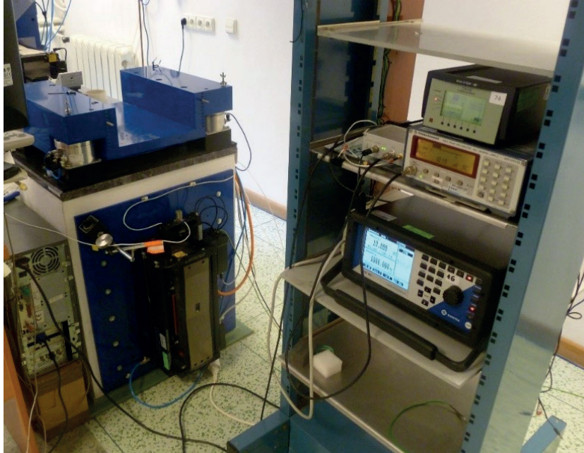
Stanowisko do wzorcowania przyrządów do pomiaru drgań mechanicznych w zakresie małych częstotliwości
