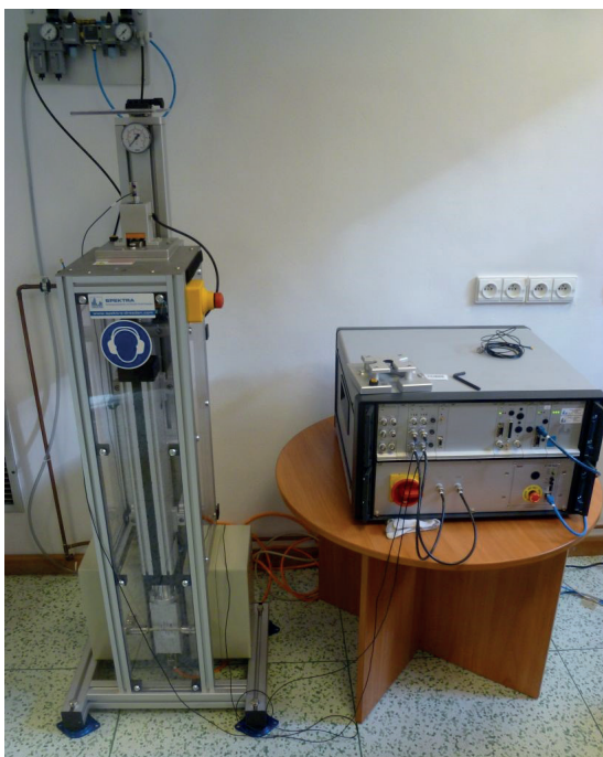
Stanowisko do wzorcowania przetworników przy pobudzeniu udarowym metodą porównawczą
