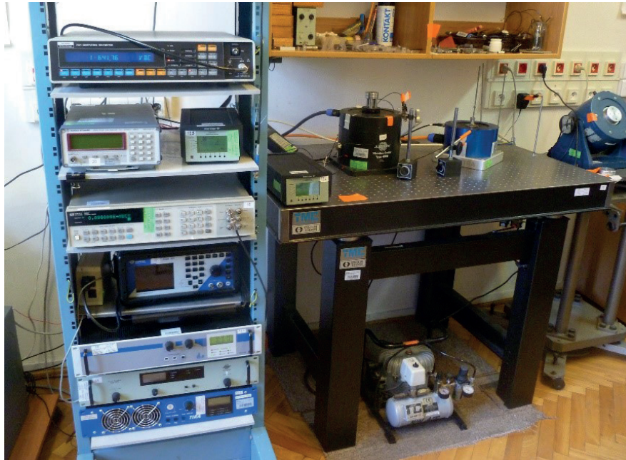
Stanowisko do wzorcowania przyrządów do pomiaru drgań mechanicznych metodami wtórnymi
