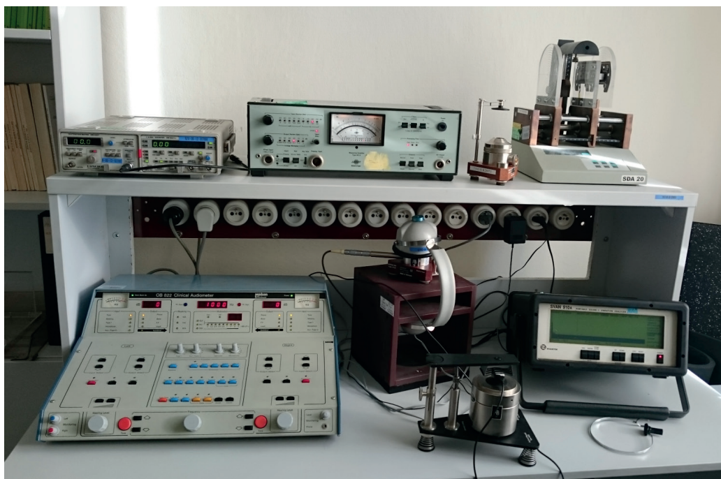
Stanowisko do wzorcowania urządzeń audiometrycznych
