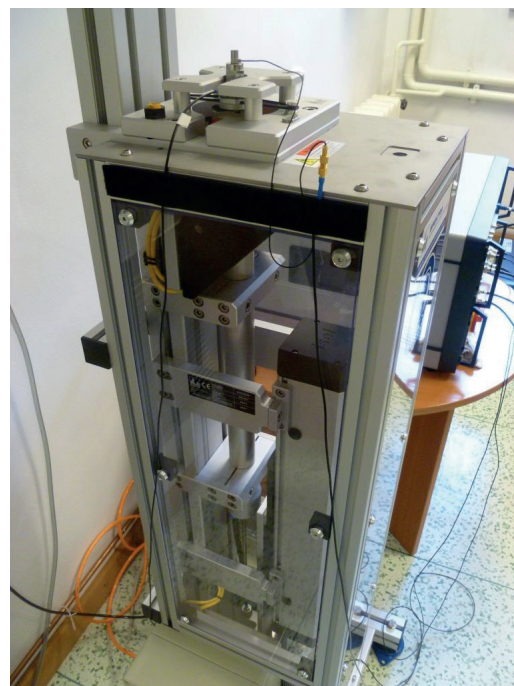
Stanowisko do wzorcowania przetworników przy pobudzeniu udarowym metodą porównawczą
