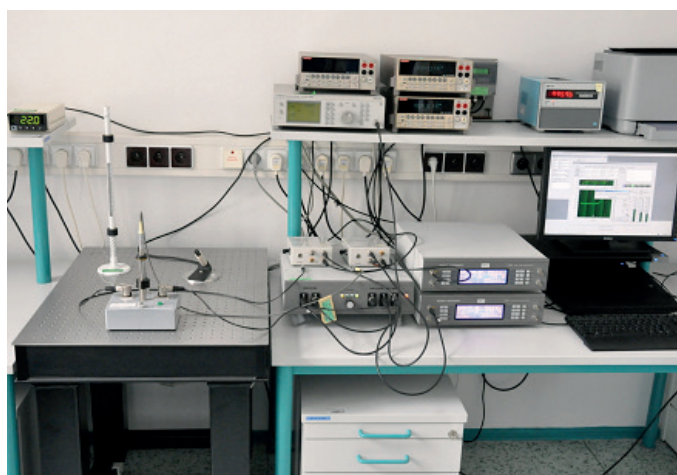
Układ do wyznaczania elektrycznej impedancji przeniesienia pary sprzężonych ciśnieniowo mikrofonów
