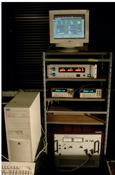
Stanowisko pomiarowe do wzorcowania wzorców temperatury barwowej
