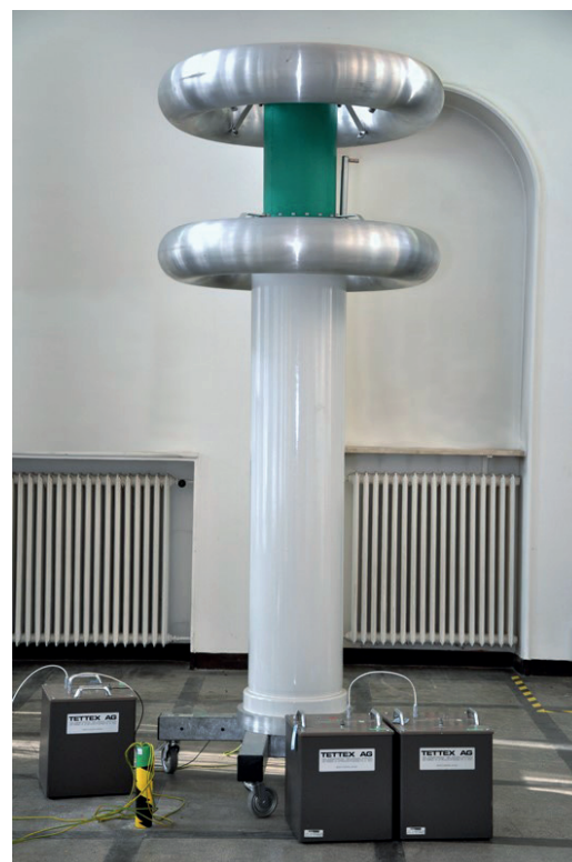
Państwowy wzorzec stosunku napięć elektrycznych przemiennych o częstotliwości 50 Hz
