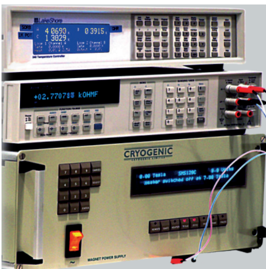
Kontroler temperatury i magnesu nadprzewodnikowego
