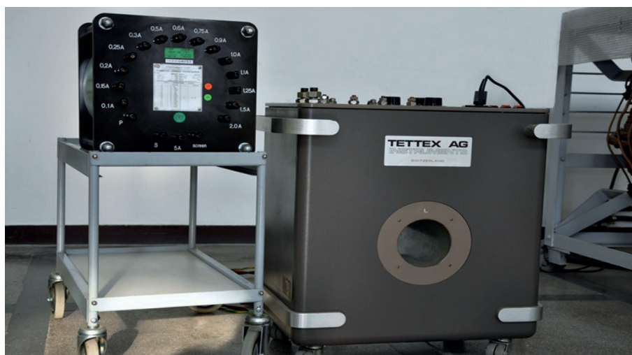
Państwowy wzorzec stosunku prądów elektrycznych przemiennych o częstotliwości 50 Hz
