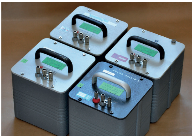
Cewki wzorcowe typu 1482-H, główny element państwowego wzorca indukcyjności
