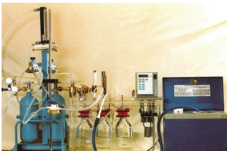
Stanowisko do badania i wzorcowania analizatorów wydechu w roku 1994
