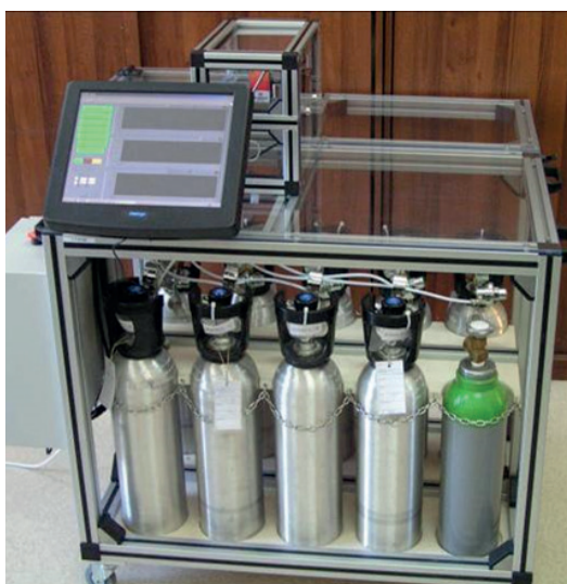
Widok stanowiska do badania analizatorów wydechu z zastosowaniem suchych wzorców gazowych, 2014 r.
