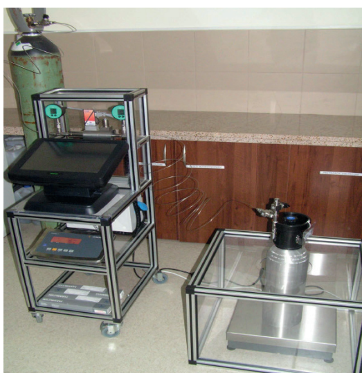
Widok stanowiska do wytwarzania suchych wzorców gazowych etanolu, 2014 r.
