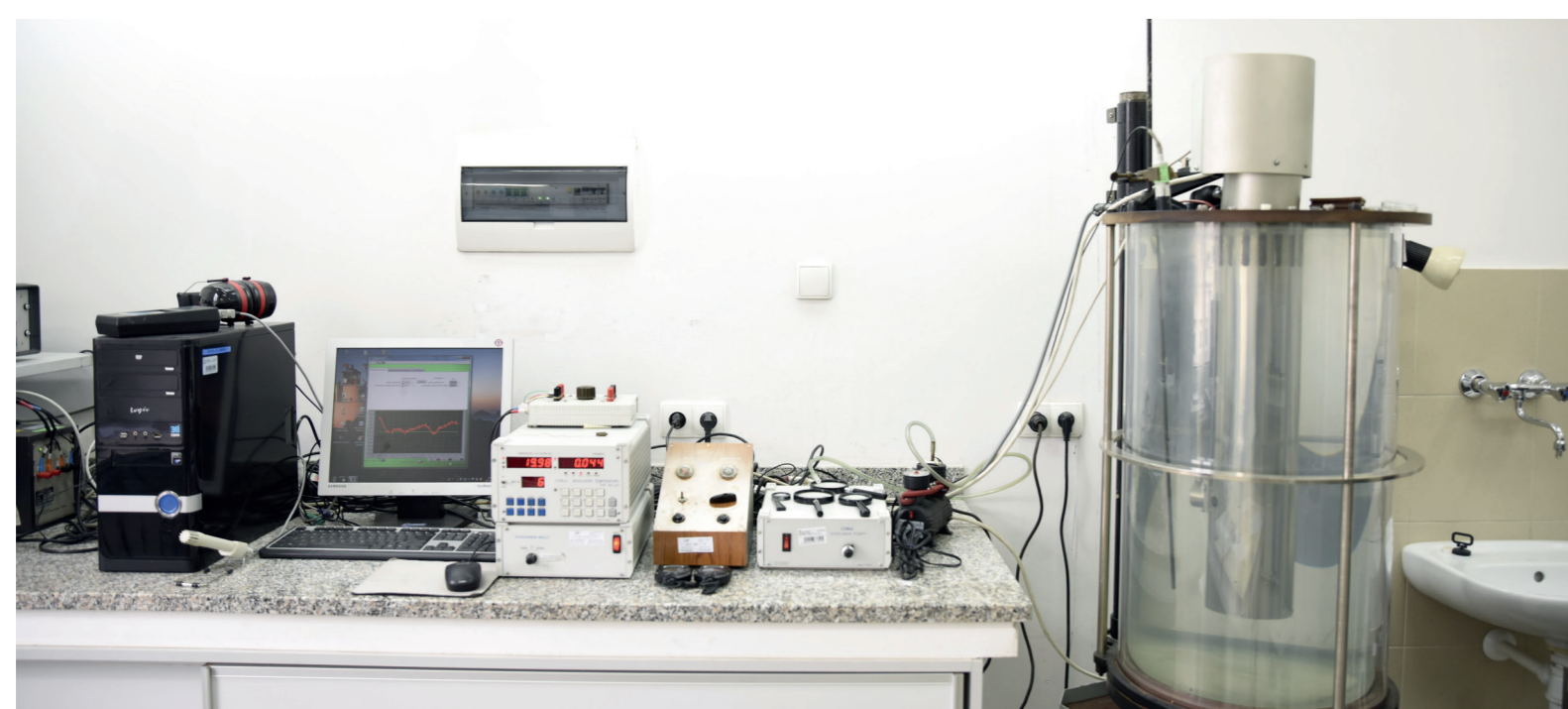
Stanowisko pomiarowe (S01) wzorca odniesienia jednostki miary lepkości – do wzorcowania wzorcowych wiskozymetrów kapilarnych szklanych oraz wzorców lepkości cieczy w temp. 20,00 °C
