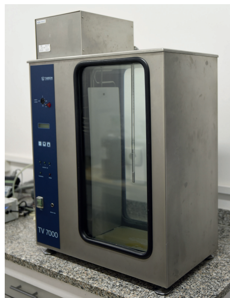
Stanowisko pomiarowe (S02) wzorca odniesienia jednostki miary lepkości – do wzorcowania użytkowych wiskozymetrów kapilarnych szklanych oraz wzorców lepkości cieczy w temp. wyższych niż 20,00 °C
