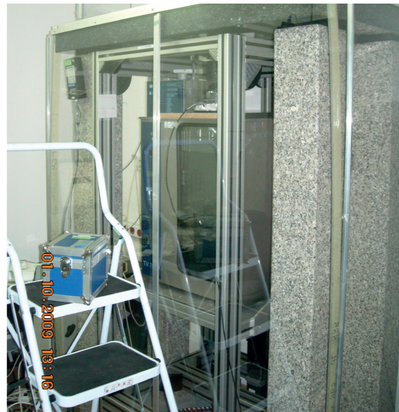
Stanowiska ważenia hydrostatycznego do pomiarów gęstości cieczy
