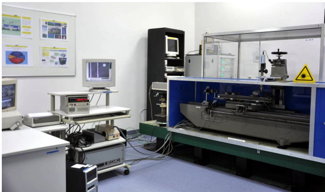
Rys. 1. Stanowisko komparatora interferencyjnego do wzorcowania wzorców kreskowych
