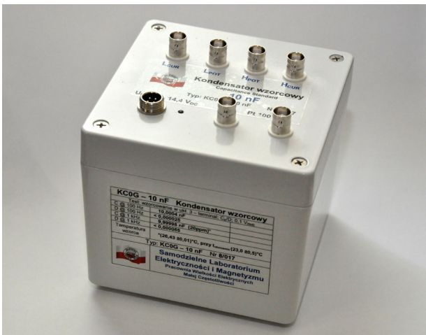
Rys. 1. Widok kondensatora wzorcowego 10 nF zbudowanego w GUM
