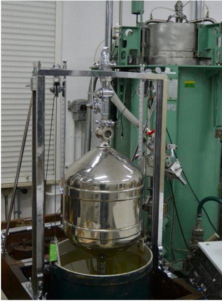
Rys. 1. Układ z kolbą pomiarową 25 dm 3 – wzorcowanie stanowiska z kontrolnym zbiornikiem dzwonowym metodą objętościową
