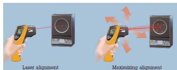
Rys. 5. Centrowanie termometru na podczerwień na powierzchni kalibratora [5]
