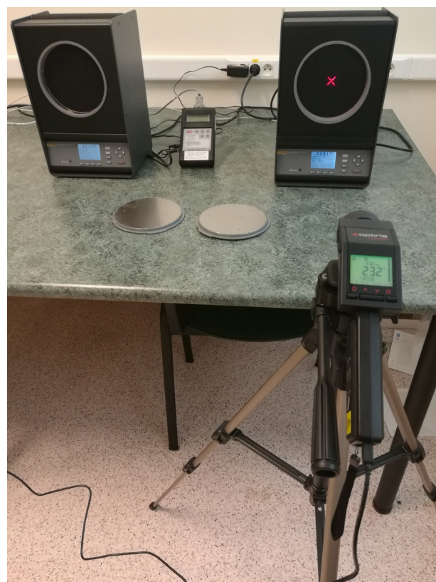
Rys. 2. Stanowisko do wzorcowania pirometrów radiacyjnych w OUM Gdańsk
