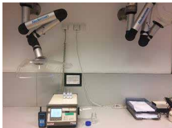
Rys. 12. Stanowisko pomiarowe przeznaczone do wzorcowania gęstościomierzy oscylacyjnych
