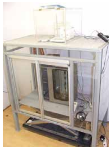
Rys. 9. Stanowisko pomiarowe do wzorcowania i legalizacji areometrów metodą ważenia hydrostatycznego
