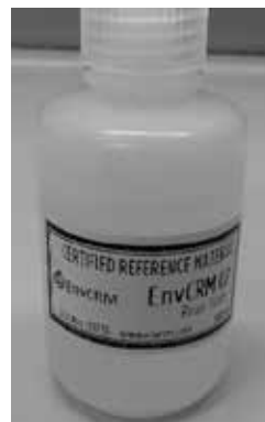
Rys. 2. Kandydat EnvCRM 02 zawierający śladowe ilości Cd, Ni, Pb, As i Se w matrycy wód rzecznych
