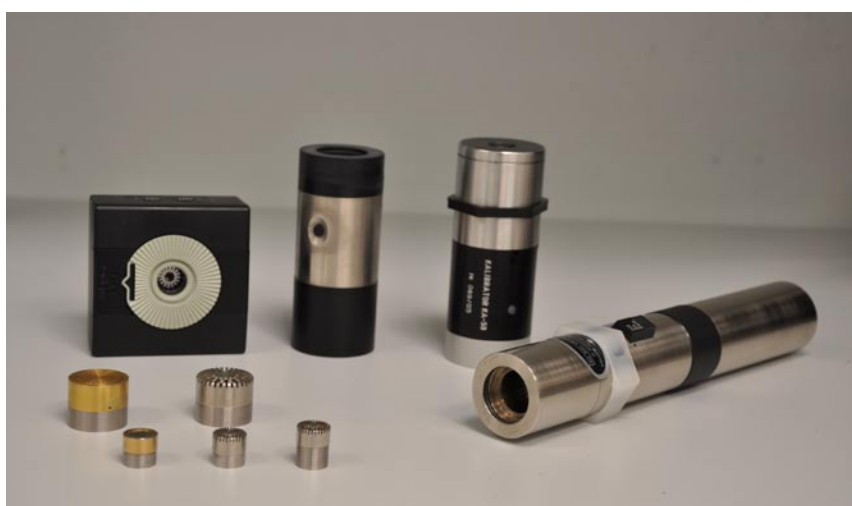
Rys. 1. Zestaw przetworników ciśnienia akustycznego (elektrostatyczne mikrofony pomiarowe) i wzorcowych źródeł ciśnienia akustycznego (kalibratory akustyczne).
