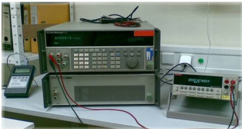
Wzorcowanie multimetru przy pomocy kalibratora Fluke 5700A
