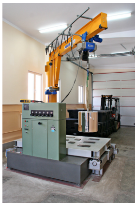
Pracownia Dużych Wzorców Masy w Obwodowym Urzędzie Miar w Siedlcach – na wagę legalizacyjną wstawiany jest wzorzec masy kl. F 2 o masie 1000 kg (za nim wzorce masy żeliwne kl. M 1 o masie 1000 kg)
