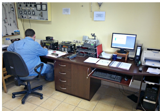
Legalizacja taksometrów na stanowisku kontrolnym w Obw. UM w Lublinie
