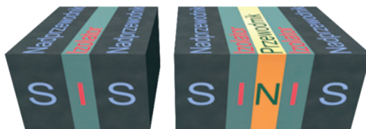
Rys. 5. Struktura złącz Josephsona stosowanych we wzorcach napięcia
