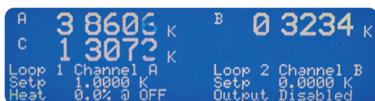
Rys. 17. Temperatury w układzie kriogenicznym (ekran kontrolera temperatury LakeShore 340): A – temp. pompy sorpcyjnej, B – temp. próbki, C – temp. chłodnicy
