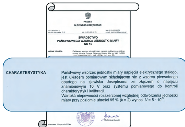
Rys. 3. Świadectwo państwowego wzorca napięcia
