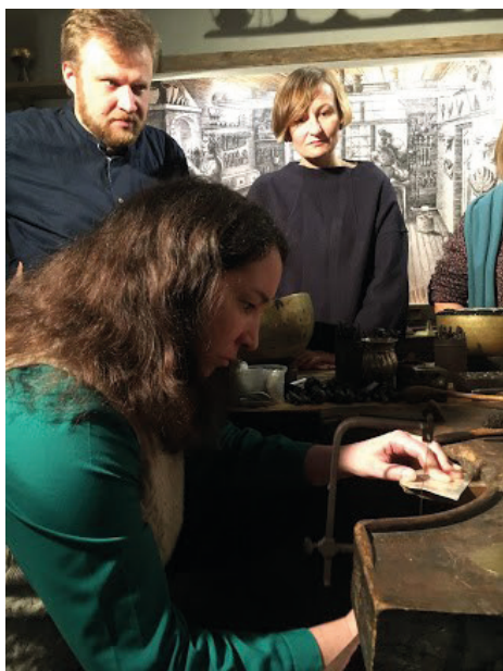
Fot. 3. Cięcie blachy za pomocą gesztelki
