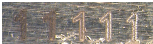
Rys. 9. Wzrost prędkości przesuwania wiązki lasera po znakowanej powierzchni. Niskie prędkości (z lewej strony) zwiększają ryzyko nadpalenia znakowanej powierzchni. Wysokie wartości (z prawej strony) obniżają jakość znaku w postaci rozproszonego śladu, czego efektem jest znakowanie „kropkowane”. Optymalna wartość uzyskana została w środkowej próbie.
