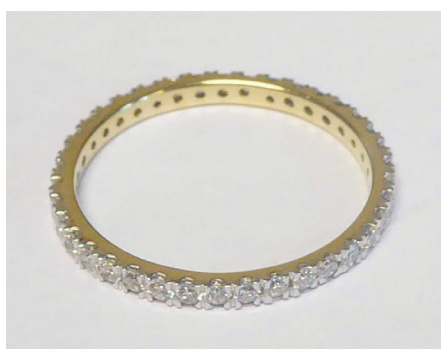
Rys. 2. Pierścionek, w którym kamienie – gęsto rozmieszczone wzdłuż szyny – utrudniają i zawężają dostęp do powierzchni oznaczania
