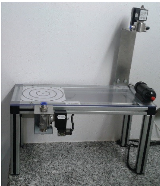
Rys. 11. Skompletowane i zmontowane stanowisko do konfekcjonowania CRM
