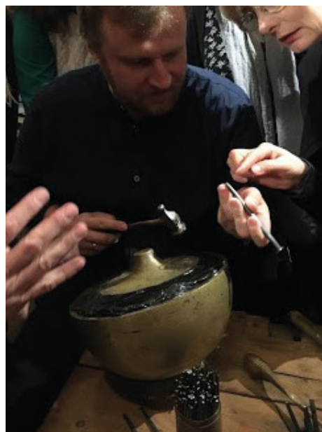
Fot. 4. Cyzelowanie za pomocą puncyn i młotków cyzellerskich
