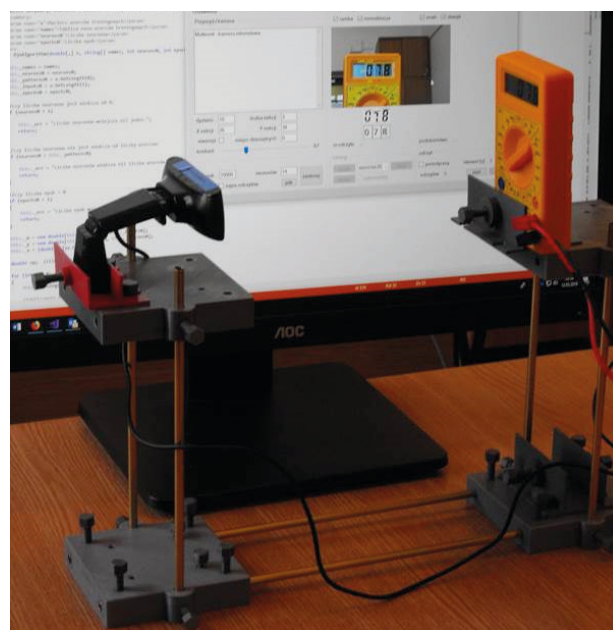
Rys. 1. Konstrukcja układu odczytu wskazań
