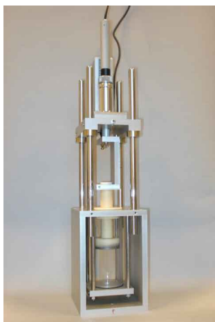
Rys. 2. Tłokowe naczynie konduktometryczne przeznaczone do pomiarów przewodności elektrycznej właściwej elektrolitów metodą podstawową (GUM)
