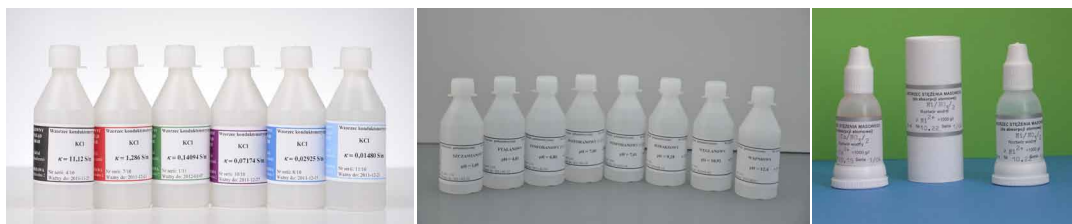
Wzorce konduktometryczne, wzorce pH i wzorce stężenia masowego wytwarzane w Zakładzie Fizykochemii GUM
