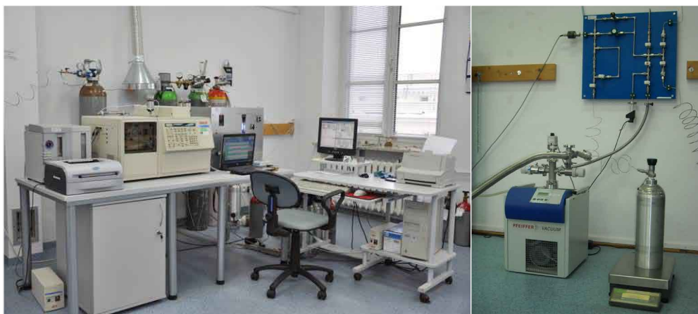
Stanowisko do wzorcowania mieszanin gazowych metodą chromatograficzną oraz stanowisko do wytwarzania wzorców gazowych metodą grawimetryczną (2011 r.)
