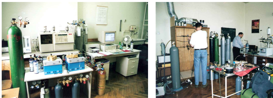
Stanowisko do wzorcowania mieszanin gazowych metodą chromatograficzną oraz stanowisko do wytwarzania wzorców gazowych metodą grawimetryczną (1997 r.)
