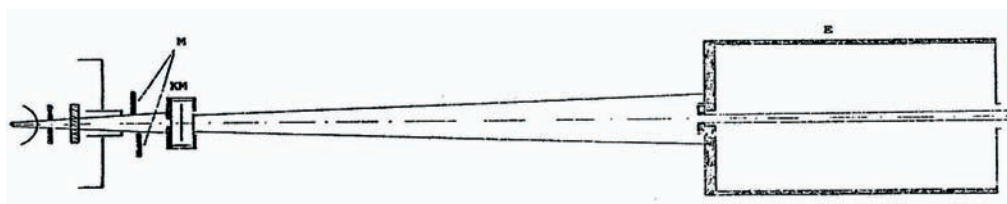
Schemat stanowiska pomiarowego do wzorcowania w polu promieniowania X
