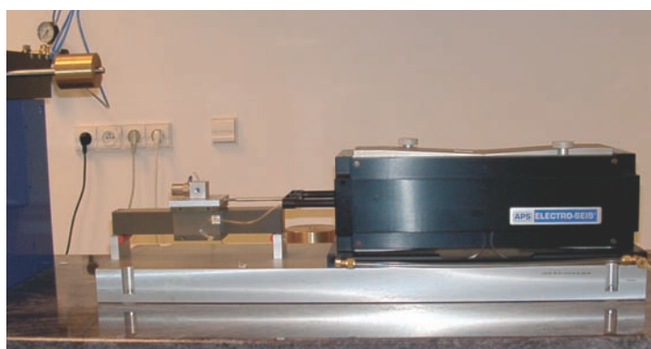
Fragment stanowiska ze wzbudnikiem APS
