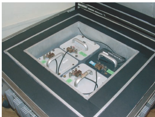
Wzorce indukcyjności 10 mH w termostacie
