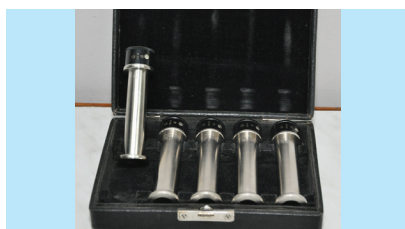
Państwowy wzorzec jednostki kąta skręcenia płaszczyzny polaryzacji płaskopolaryzowanej fali świetlnej w widzialnym zakresie widma – kwarcowe płytki kontrolne
