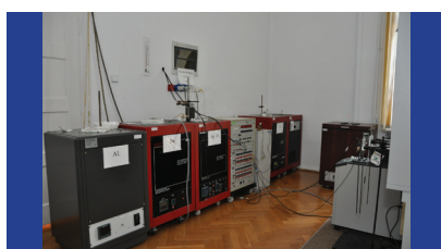
Państwowy wzorzec pomiarowy jednostki temperatury w zakresie od -189,3442 °C do 961,76 °C
