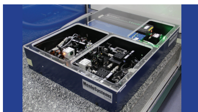
Państwowy wzorzec jednostki długości – stanowisko pomiarowe do odtwarzania jednostki długości – syntetyzer częstotliwości
