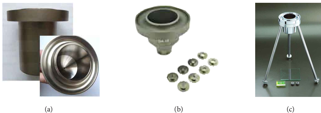
Rys. 2. (a) Kubek wypływowy z dnem stożkowym; (b) kubek Forda z wymiennymi dyszami; (c) kubek wypływowy Forda w statywie.
