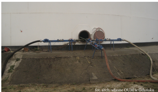
Fot. 3. Wzorcowanie zbiornika metodą objętościową
