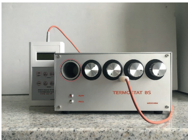
Rys. 5. Termostat BS z zaznaczonym gniazdem, w którym umieszcza się wzorzec
