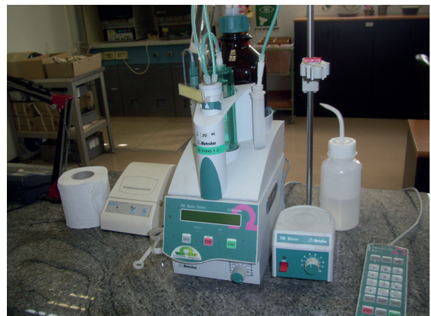
Potencjometr do analizowania stopów srebra bez automatycznego podajnika
