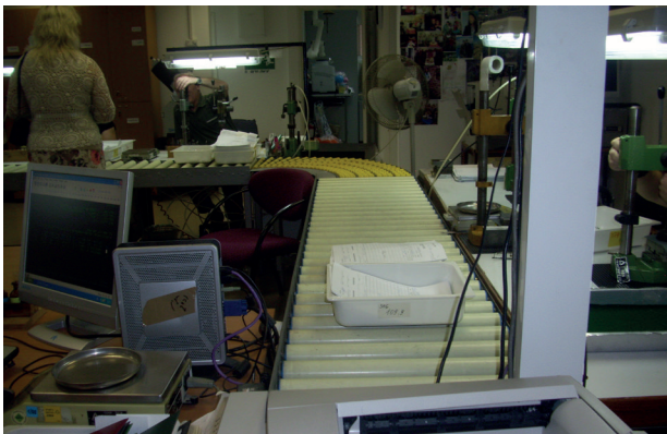
Rolki podawcze do przesuwania wyrobów pomiędzy stanowiskami
