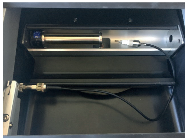
Rys. 4. Wnętrze komory pomiarowej z wmontowanym czujnikiem Pt 100 i kwarcową płytką kontrolną
