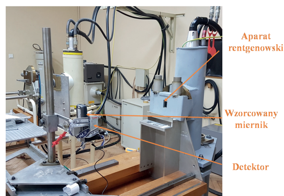
Rys. 3. Układ pomiarowy z aparatem rentgenowskim YXLON MG 325/45
