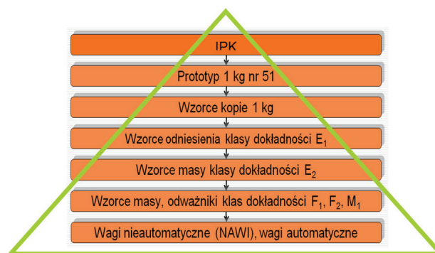
Rys. 4. Uproszczony schemat hierarchicznego układu sprawdzeń w GUM
