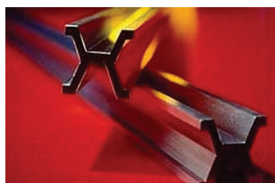
Międzynarodowy prototyp metra w postaci pręta ze stopu platyny i irydu, służył jako wzorec międzynarodowy w latach 1889–1960.
