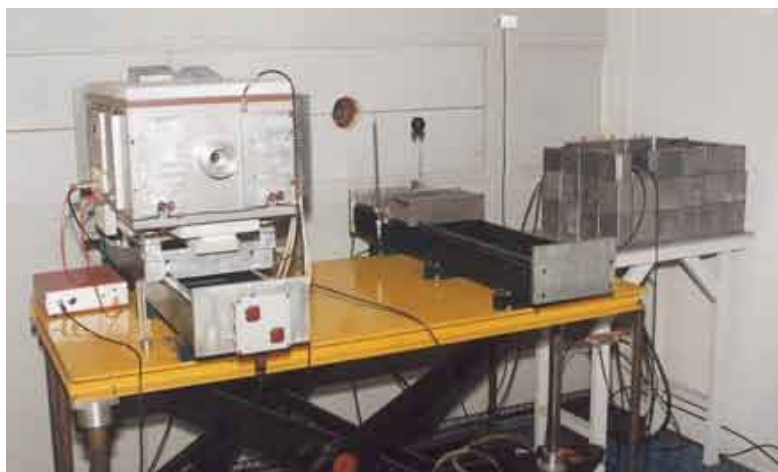
Rys. 6. Powietrzna komora jonizacyjna BIPM będąca pierwotnym wzorcem w zakresie promieniowania X Źródło: BIPM
