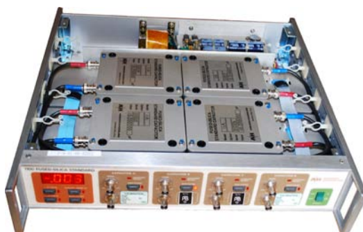
Kondensatory AH11A w obudowie AH 1100
