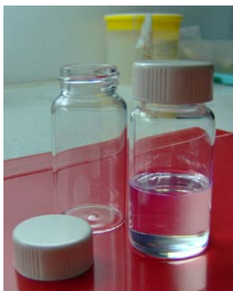
Naczynka pomiarowe wykorzystywane w układach państwowego wzorca JMAPR
