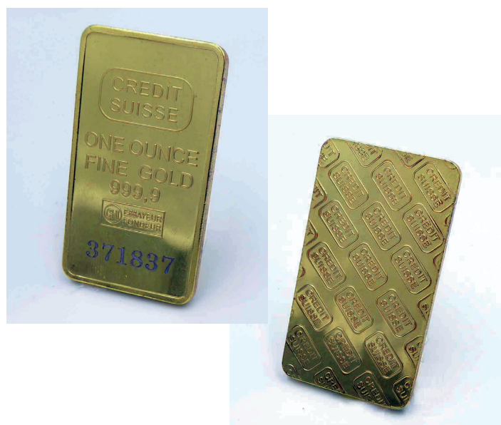
Rys. 8. Falsyfikat imitujący wyglądem i masą uncjową sztabkę czystego złota
