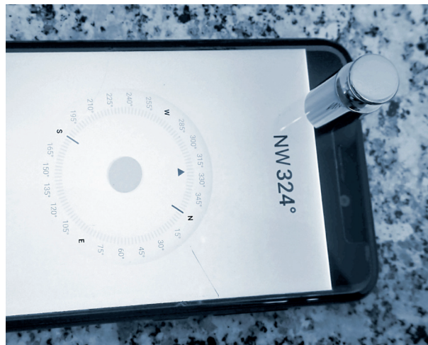
Rys. 6. Wzorzec masy 10 g, klasy dokładności E 2 . Polaryzacja zmierzona za pomocą susceptometru wynosi -27 μT
