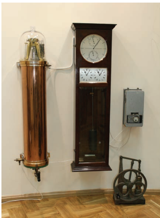
Obecnie działający zegar Shortta w Olsztyńskim Planetarium i Obserwatorium Astronomicznym. Po lewej stronie: zegar główny, pośrodku: zegar pomocniczy z układem tarcz i wskazówek, po prawej: źródło zasilania zegara i pozostałości po ręcznej pompie próżniowej
