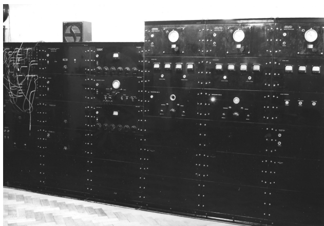
Ilustr. 7. Zegary kwarcowe i urządzenia do generacji elektrycznych sygnałów czasu w Głównym Urzędzie Miar (zdjęcie wykonano prawdopodobnie w latach 60. XX w.)
