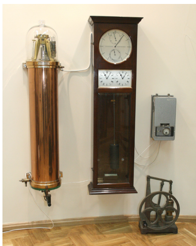
Ilustr. 3. Obecnie działający zegar Shortta w Olsztyńskim Planetarium i Obserwatorium Astronomicznym. Po lewej stronie: zegar główny, pośrodku: zegar pomocniczy z układem tarcz i wskazówek, po prawej: źródło zasilania zegara i pozostałości po ręcznej pompie próżniowej (fot. Olsztyńskie Planetarium i Obserwatorium Astronomiczne)
