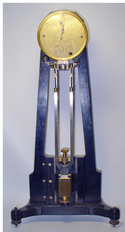
Ilustr. 6. Zegar kamertonowy. Zamiast ruchu wahadła, mechanizm zegarowy napędzany był podtrzymywanymi elektrycznie drganiami kamertonu o częstotliwości 100 Hz. Tego typu zegary służyły do precyzyjnych pomiarów czasu i stanowiły jednocześnie wzorzec częstotliwości, użył go również Michelson do pomiaru prędkości światła w 1882 roku (źródło: http://www.phys.cwru.edu/ccpi/Fork_clock/Fork_clock.jpg )
