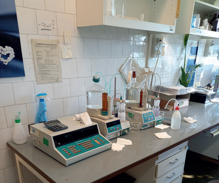
■ Określenie zawartości srebra metodą potencjometryczną
