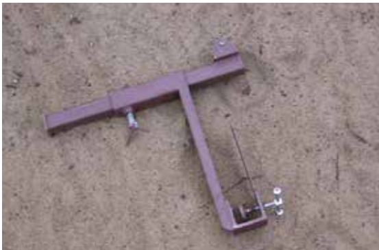
Zdjęcie uchwyty. Uchwyt posiada możliwość regulacji położenia górnego punktu odniesienia linii pionu. W górnym prawym rogu uchwyty znajduje się bloczek do nawinięcia linki (konstrukcja własna administracji miar). fot. arch. własne
