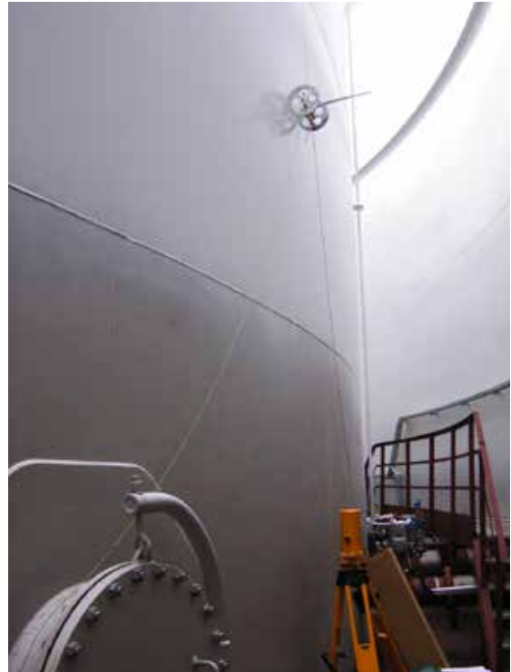
Zdjęcie pionownika optycznego będącego na wyposażeniu administracji miar. Na zdjęciu jest widoczny również wózek magnetyczny z podzielnia.
