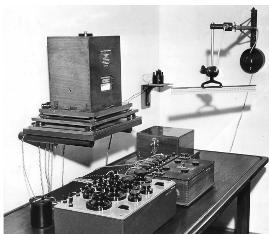
Ilustr. 3. Komparator prądu przemiennego ze stałym, firmy Elliott-Fischer; zakres: 0,5 – 5 A, 125 – 250 V, 50 – 60 Hz (1962) (Archiwum GUM)
