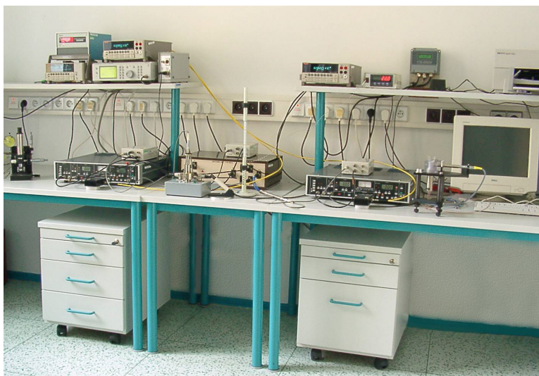
Ilustr. 2. Stanowisko wzorca podstawowego jednostki ciśnienia akustycznego
