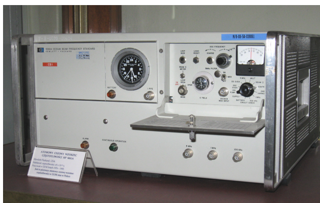
Ilustr. 9. Pierwszy cezowy zegar atomowy w Polsce. Posiada jeszcze 24-godziną tarczę ze wskazówkami Pracował w Głównym Urzędzie Miar w latach 1976–1995
