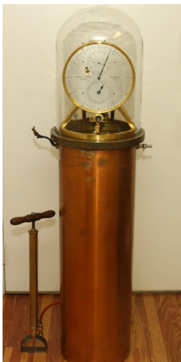
Ilustr. 6. Zegar kamertonowy. Zamiast ruchu wahadła, mechanizm zegarowy napędzany był podtrzymywanymi elektrycznie drganiami kamertonu o częstotliwości 100 Hz. Tego typu zegary służyły do precyzyjnych pomiarów czasu i stanowiły jednocześnie wzorzec częstotliwości, użył go również Michelson do pomiaru prędkości światła w 1882 roku (źródło: http://www.phys.cwru.edu/ccpi/Fork_clock/Fork_clock.jpg )
