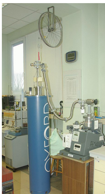
Rys. 7. Kriostat do realizacji punktu potrójnego argonu w INTiBS PAN, komórka z argonem (a), wstawkę dla CSPRT (b)
