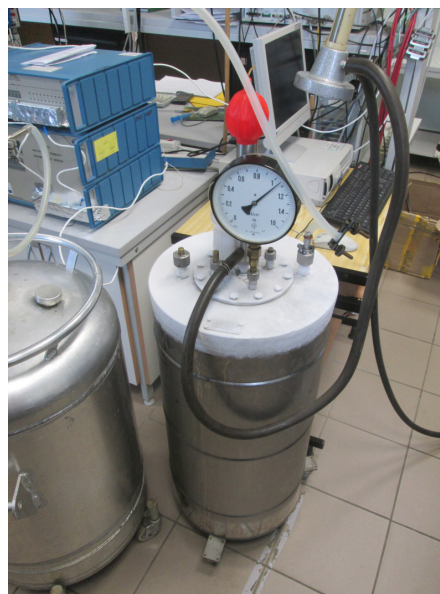
Rys. 2. Kriostat do realizacji punktu potrójnego argonu w GUM
