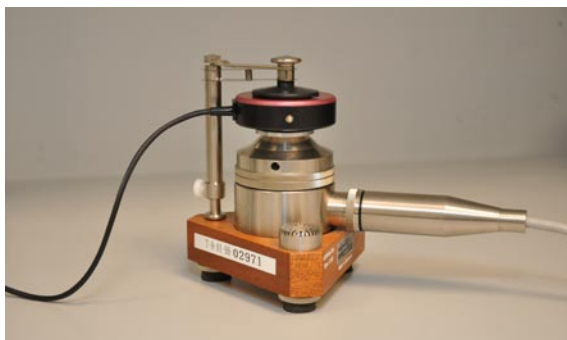
Rys. 9. Przykład złożonego akustycznego układu pomiarowego: audiometryczny sprzęgacz akustyczny typu 4153, połączony ze słuchawką pomiarową DT48 stanowiącą źródło ciśnienia akustycznego.
