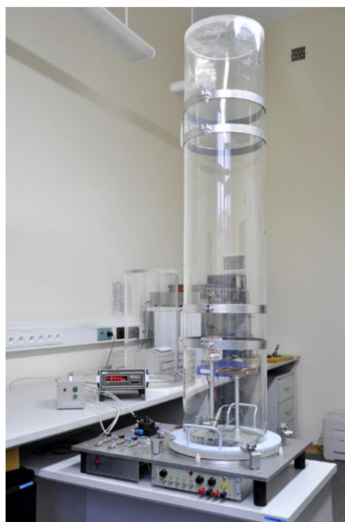
Rys. 5. Stanowisko pomiarowe z komorą ciśnieniową o objętości 93 dm 3 oraz akustyczna sonda pomiarowa stosowana w systemach monitoringu hałasów lotniczych.
