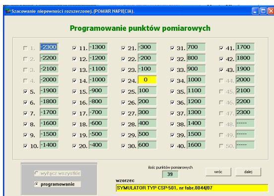
Rys. 4. Interfejs programowania punktów pomiarowych napięcia opr. własne
