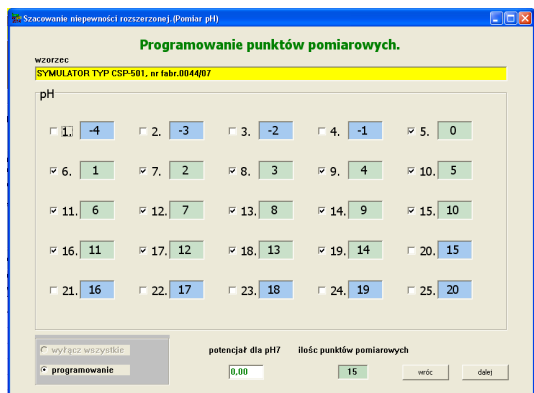
Rys. 3. Interfejs programowania punktów pomiarowych pH opr. własne
