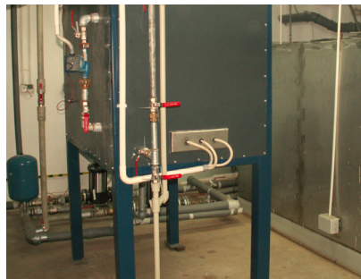
Zbiorniki magazynowe wody oraz układ pomp zasilających stanowisko
