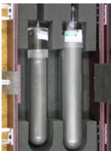
Komórki do realizacji punktów krzepnięcia indu ( 156,5985\text{ }^{\circ}\text{C} ) i cyny ( 231,928\text{ }^{\circ}\text{C} )
