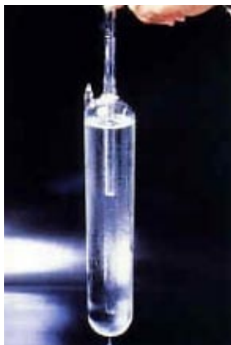
Komórki do realizacji punktu potrójnego wody ( 0,01\text{ }^{\circ}\text{C} ) z widocznym płaszczem lodu
