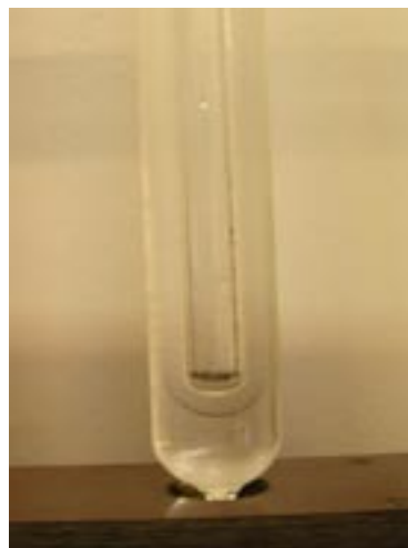
Komórki do realizacji punktu potrójnego wody ( 0,01\text{ }^{\circ}\text{C} ) z widocznym płaszczem lodu
