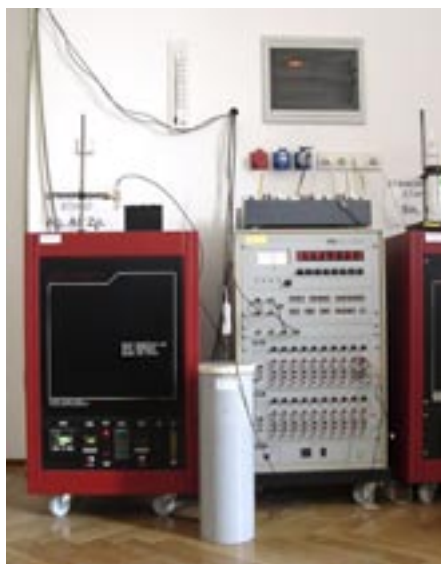
Piec do realizacji punktów krzepnięcia Ag, Al i Zn oraz mostek rezystancyjny
