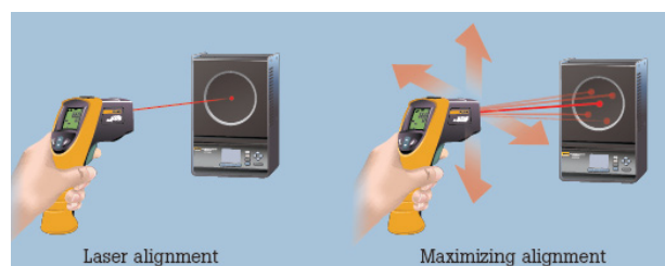
Rys. 5. Centrowanie termometru na podczerwień na powierzchni kalibratora [5]
