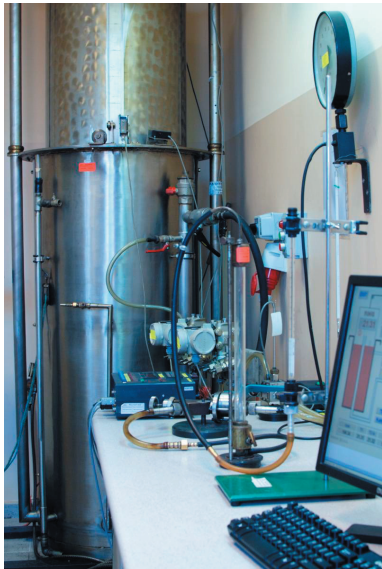
Stanowisko pomiarowe do wzorcowania rotametrów
