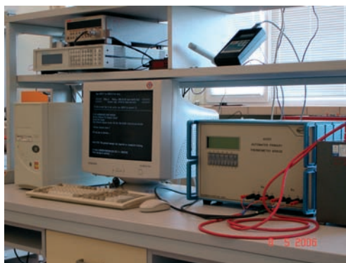
Mostek MI 6015 T do pomiaru rezystancji termometrów platynowych
