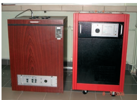
Termostaty do realizacji punktu potrójnego wody i rtęci
