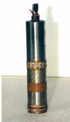
Komórka do realizacji punktu potrójnego tlenu
