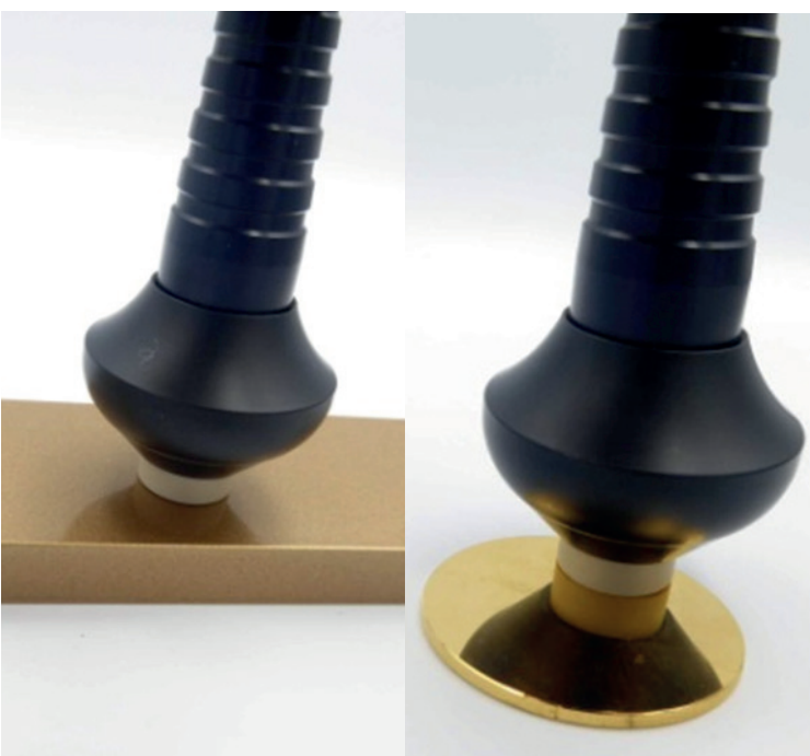
Rys. 4. Głowica sondy w trakcie wykonywania pomiaru sztabki i monety
