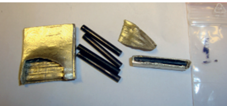
Rys.1. Przykład sztabki złota wypełnionej prętami z wolframu
