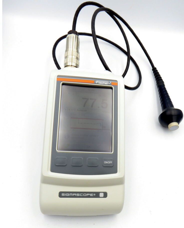
Rys. 2. Konduktometr – urządzenie stosowane w OUP w Krakowie do pomiaru konduktywności
