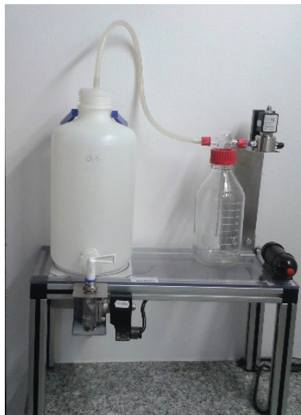
Rys. 11. Skompletowane i zmontowane stanowisko do konfekcjonowania CRM
