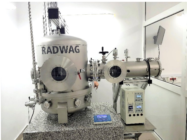
Rys. 3. Automatyczny, próżniowy komparator masy AVK-1000 (z systemem „load-lock”) w GUM
