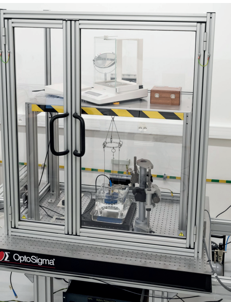
Rys. 2. System pomiarowy wzorca pierwotnego mocy ultradźwiękowej
