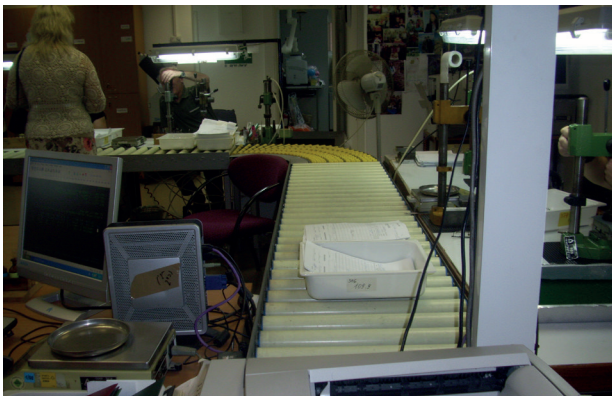
Rolki podawcze do przesuwania wyrobów pomiędzy stanowiskami
